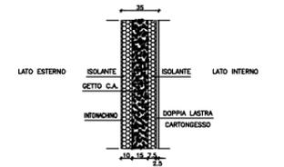
PARTICOLARE MURO DI DIVISIONE DELLE DUE UNITA'
